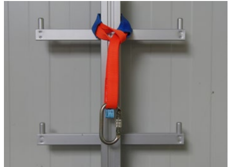
Abb. 22 Anschlag an einer Steigleiter mit Mittelholm durch Umschlingen der Schiene über einer Leitersprosse
